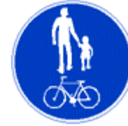
Yhdistetty pyörätie ja jalkakäytävä
